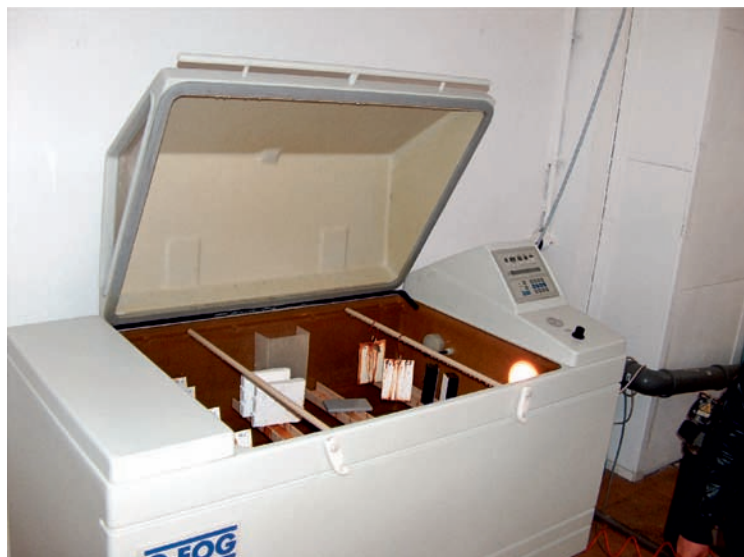
Foto 1. Aspect din activitatea de testare. Camera de ceață salină
