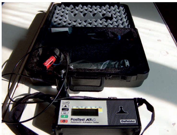
Foto 2. Aparat portabil de determinare a aderenței prin tracțiune a protecțiilor utilizat în cadrul unor investigații privind starea de degradare prin coroziune a construcțiilor
