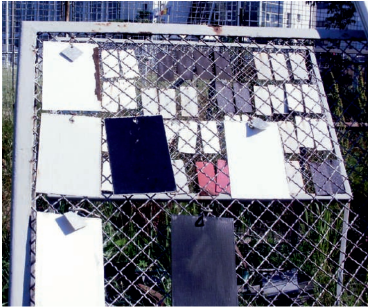
Foto 3. Aspect din activitatea de cercetare. Expunere de probe în „Poligonul de coroziune marină” din Constanța
