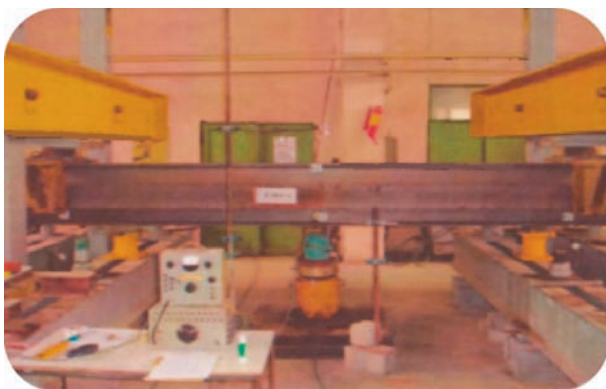
Grindă metalică solicitată la solicitări compuse
