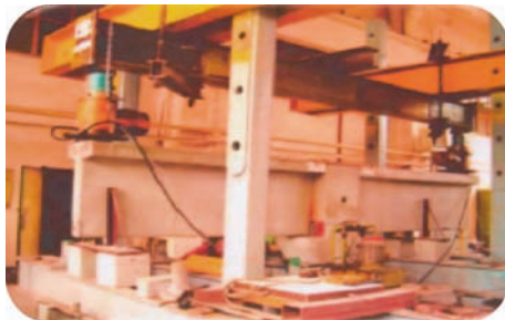
Element structural solicitat la compresiune
