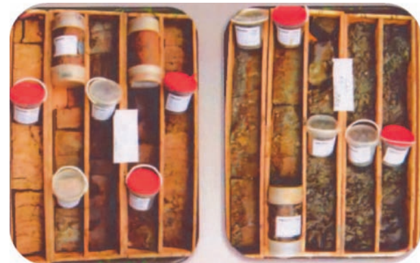
Eșantioane prelevate din terenul de fundare
